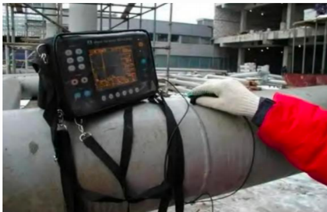
①【图 3】船舶焊缝超声波无损检测示意图 [7]
