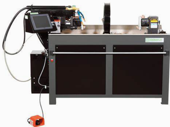
①【图 2】磁粉检测装置 [3]
